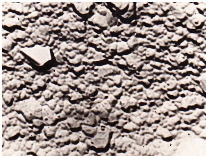
Рис. 4. Микроструктура гальванических покрытий. Разрешение \times 4500
