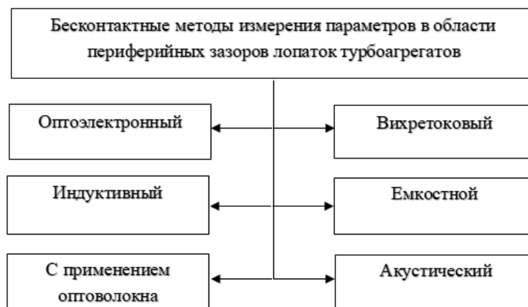
Рис. 1. Основные методы диагностики исследуемых параметров периферийных областей лопаток турбоагрегатов
